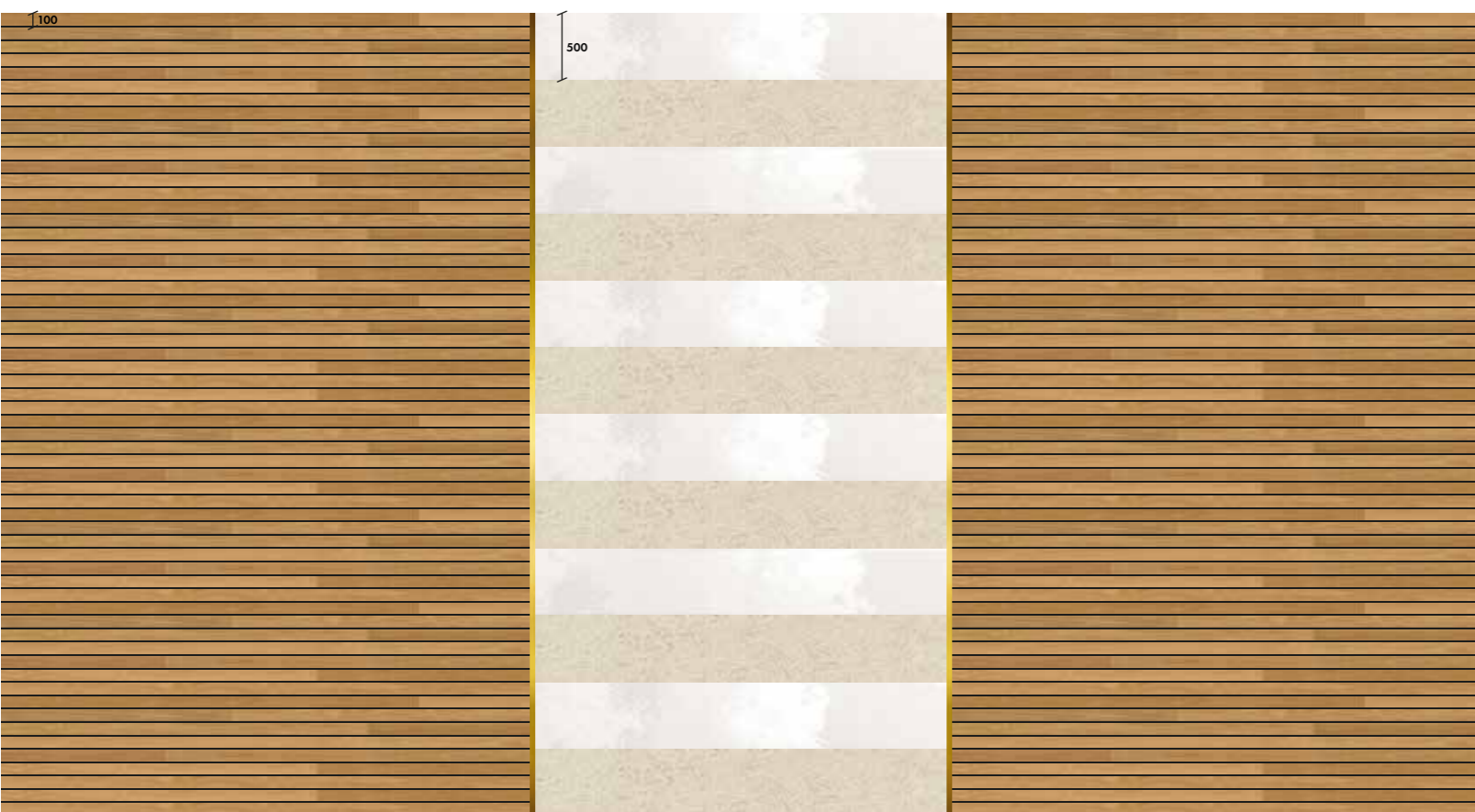
Plancher nautique bois massif & joint ton noir (option sol souple) Bayadère marbre blanc & grès cérame beige mat. jonc bronze doré
